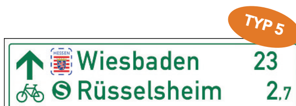
Abb. 3-10: Radwegweisung zu einem Hessischen Radfernweg; Typ Tabellenwegweiser
